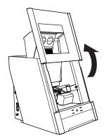
3 Oriente las partes de la forma mostrada en la imagen y luego inserte el adaptador en la abrazadera.
