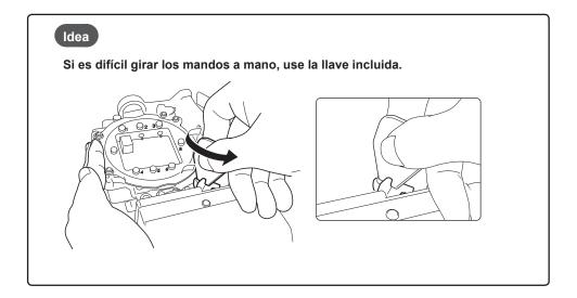
**5** Tire ligeramente del adaptador para comprobar que no se afloje.
